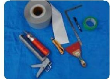
上段左から接着型テープ（幅10cm）、曲尺（差金）、油性ペン、マスキングテープ 下段左からコーキングガン、シーリング材、カッターナイフ、ゴムペラ
