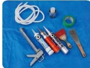
上段左からバックアップ材、プライマー（接着剤）、マスキングテープ 下段左からコーキングガン、シーリング材（左よりシリコン系、ポリウレタン系、変成シリコン系）、ゴムペラ、金ペラ
