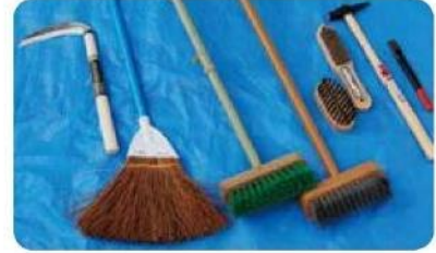
左から草刈鎌、庭ほうき、デッキブラシ（ポリエチレン製・ワイヤー製）、ワイヤーブラシ、金づち、たがね。このほかに、シーリング材は直接触れるとアレルギー症状を引き起こすことがあるので軍手など手袋は必須
